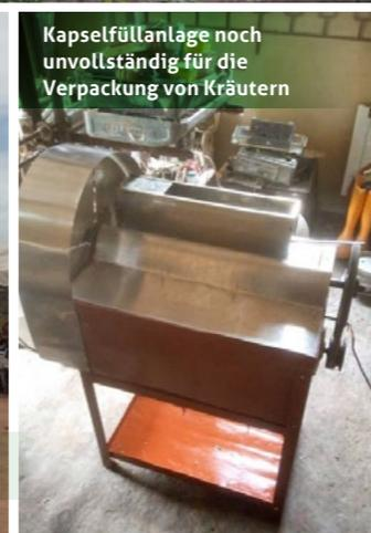
Kapselfüllanlage noch unvollständig für die Verpackung von Kräutern
